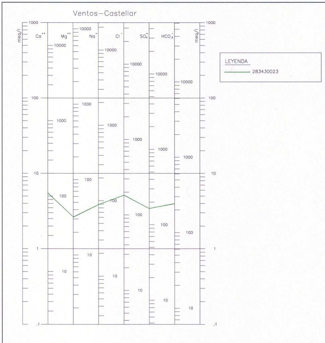
Figura 9.11 Diagrama de Schöeller-Berkaloff de las muestras analizadas en el acuífero Ventós-Castellar
