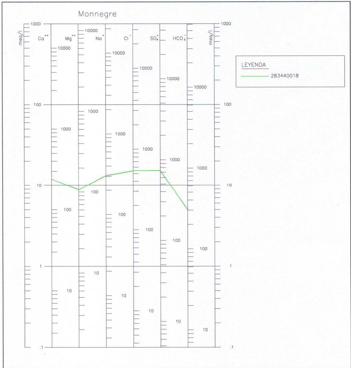
Figura 9.37 Diagrama de Schöeller-Berkaloff de las muestras analizadas en el acuífero Monnegre
